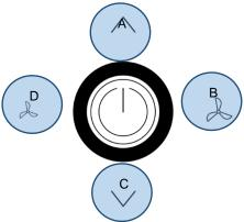
Il menu di configurazione viene attivato premendo contemporaneamente i pulsanti "su" (A), "sinistra" (D) e "destra" (B) per almeno 3 secondi.
